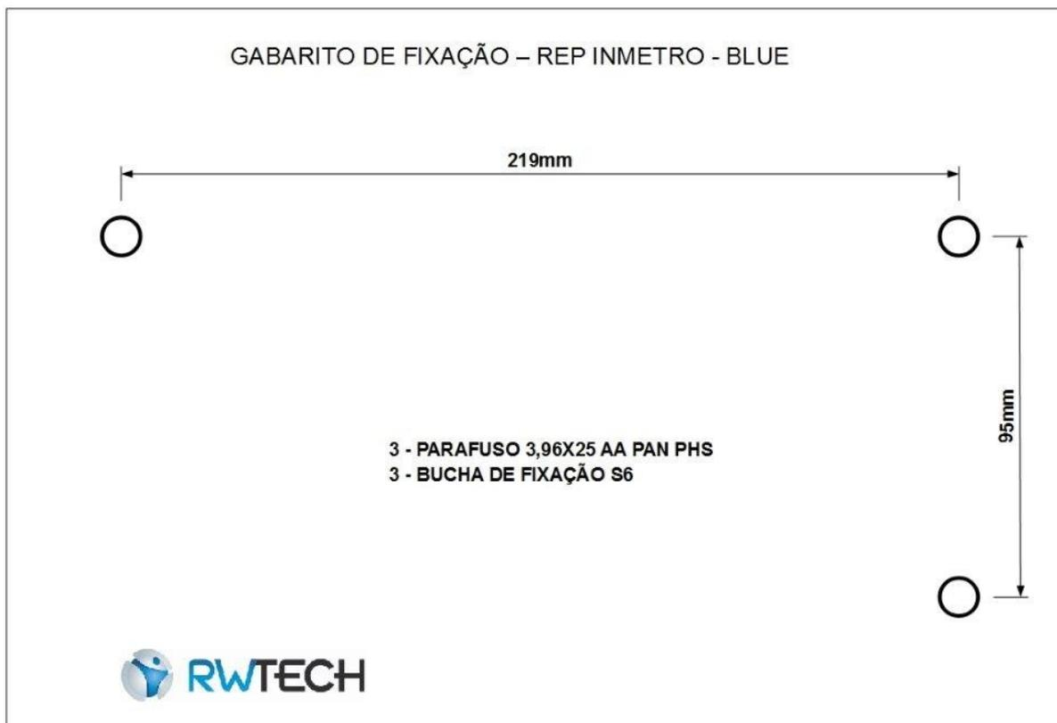
2. Furar as marcações com o auxílio de uma furadeira e fixar as três buchas de parede nos furos realizados, e então colocar os três parafusos fornecidos nas buchas, deixando um espaçamento de aproximadamente 0,5 cm entre o parafuso e a parede.
